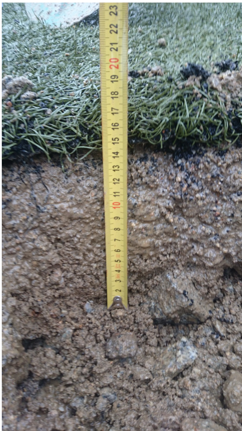
OBRÁZEK 8: SOUČASNÝ STAV MĚŘENA MOCNOST NEVHODNÉHO NEPROPUSTNÉHO ŠTĚRKOVÉHO PODKLADU
