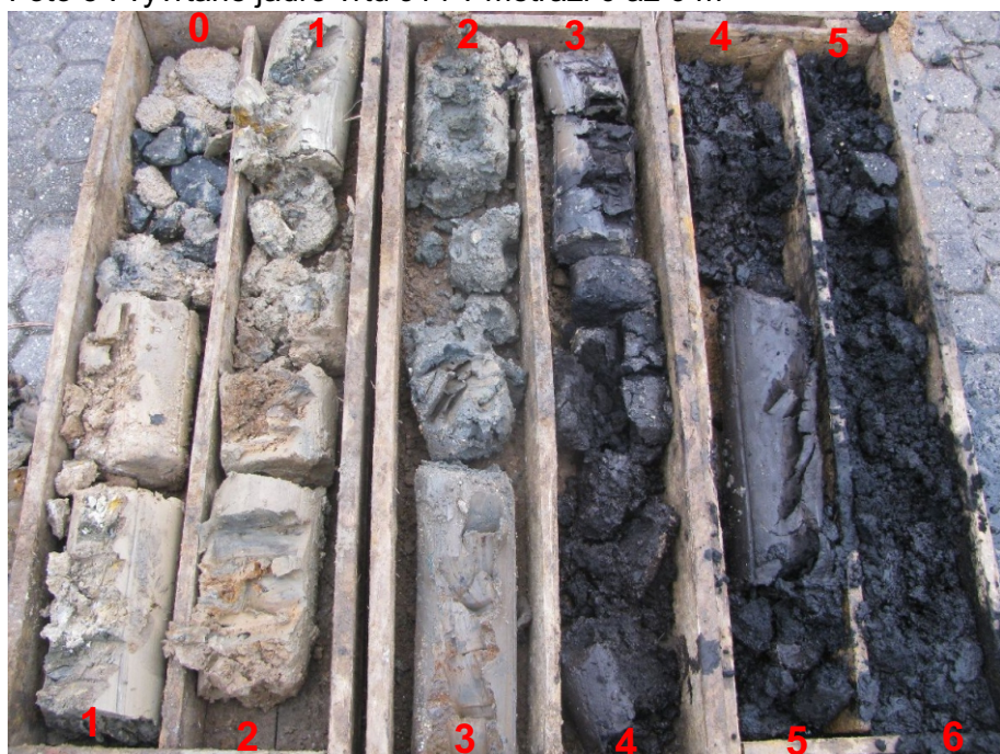
Foto 4 : vyvrtané jádro vrtu J15 v metrži 0 až 6 m
