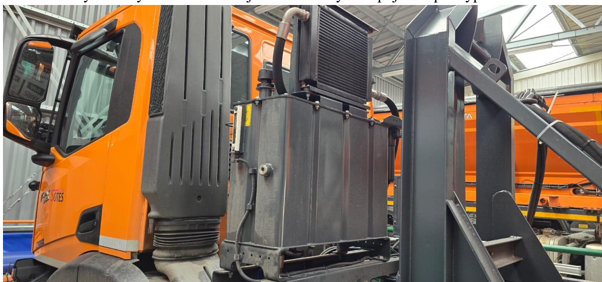
Ad 4: Podvozek je vybaven druhou nádrží hydraulického oleje o objemu 140 litrů pro okruh komunální hydrauliky s chladičem oleje a bočními rychlospojkami pro sypač.
